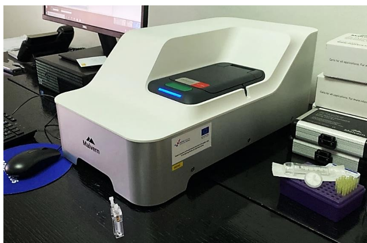
Slika 8. Uređaj Zetasizer Ultra (Malvern Pananalytical Ltd., Ujedinjeno Kraljevstvo)
