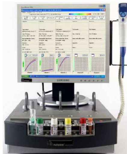
Slika 6. Multiplate ® uređaj za praćenje agregacije trombocita.
