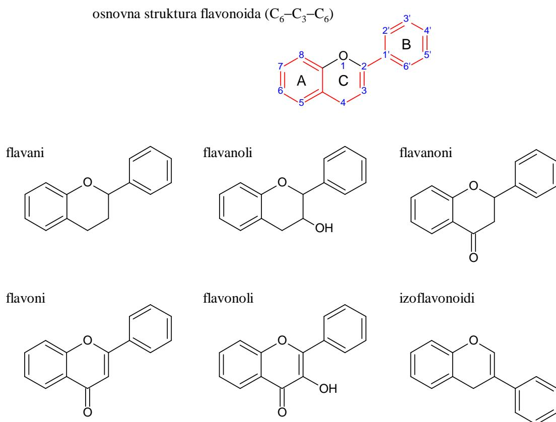
Slika 1. Osnovna struktura i klase flavonoida.<sup>1</sup>
