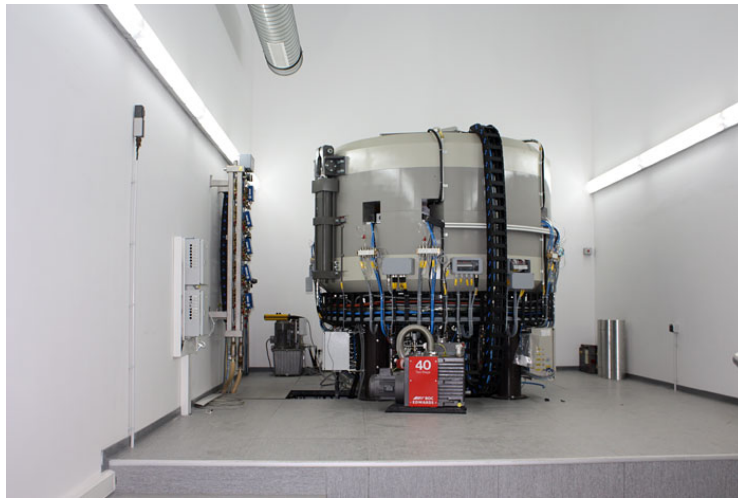
Slika 6. Ciklotron IBA, Cyclone 18/9 HC korišten u RMC-u za proizvodnju FDG-a. Preuzeto iz literaturne reference (16)
