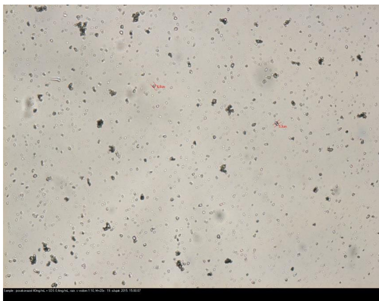
Slika 34. Primjer suspenzije s aglomeratima (posakonazol:SDS=100:1), M=20x
