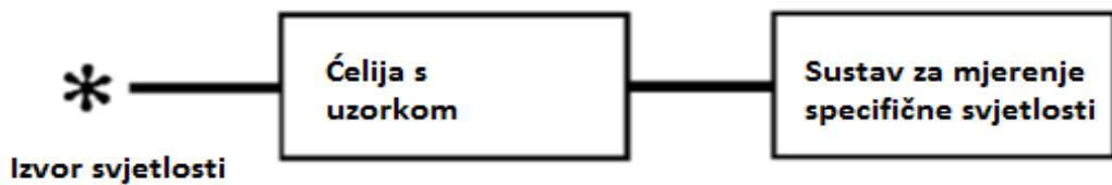
Slika 4. Osnovni dijelovi apsorpcijskog spektrometra.
