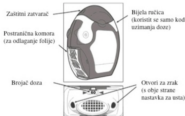
Slika 22. Shematski prikaz Forspiro® inhalera (prilagođeno prema www.halmed.hr ).
