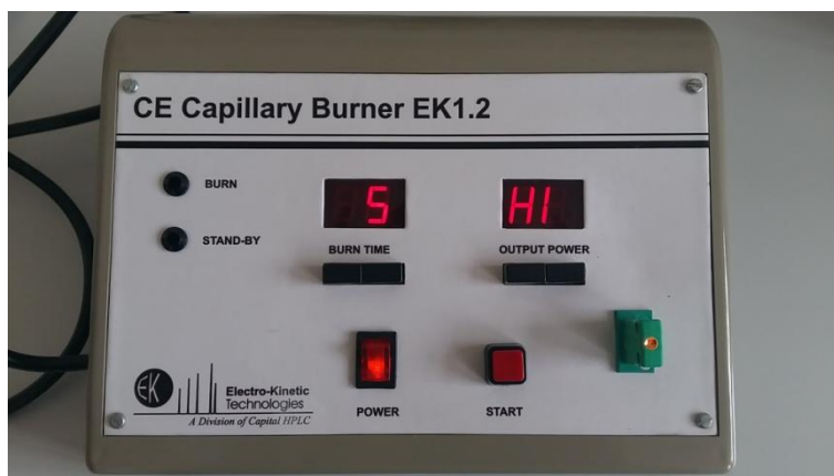
Slika 10. Aparat za uklanjanje zaštitnog poliimidnog filma na mjestu detektora pomoću užarene žice.
