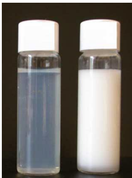
Slika 5. Nanoemulzija (lijevo) – promjer kapljica 35 nm i makroemulzija (desno) – promjer kapljica 1 \mu m (preuzeto iz Solans i sur., 2005).
