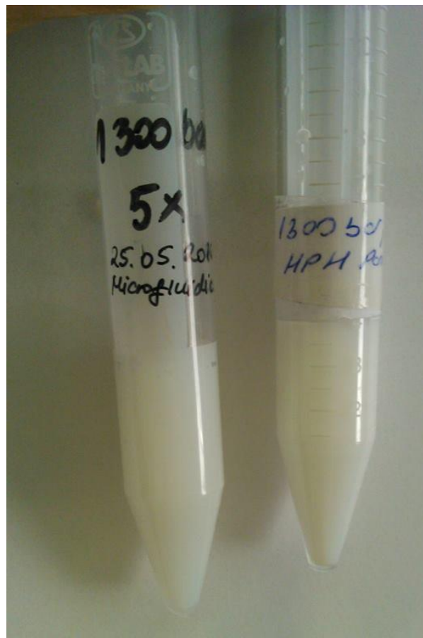
Slika 8: Nanoemuzije izradene pri tlaku od 1300 bara i pet ciklusa - mikrofluidizacija (lijevo); visokotlačna homogenizacija (desno)
