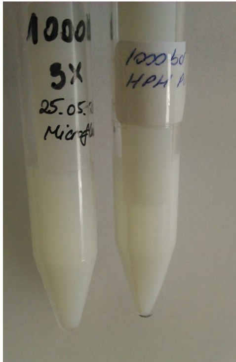
Slika 7: Nanoemuzije izradene pri tlaku od 1000 bara i tri ciklusa - mikrofluidizacija (lijevo); visokotlačna homogenizacija (desno)
