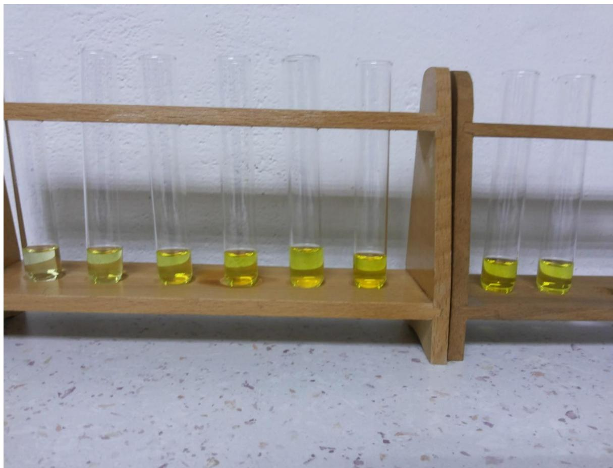
Slika 9. Pripremljena razrjeđenja kvercetina tijekom inkubacije s  $\text{AlCl}_3$
