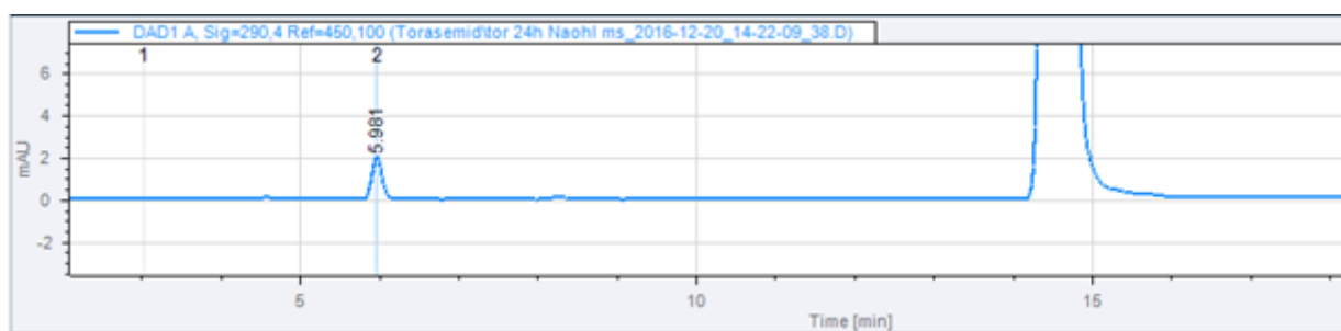
Slika 28: Kromatogram torasemida razgrađivanog 24 h u 1M NaOH nakon izlaska iz prve dimenzije, s označenim alikvotima skupljanima za drugu dimenziju
