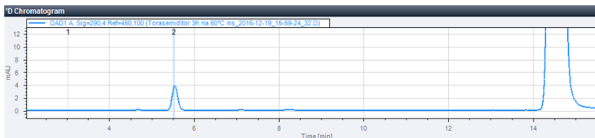
Slika 15: Kromatogram uzorka torasemida grijanog 3 sata na 60°C
