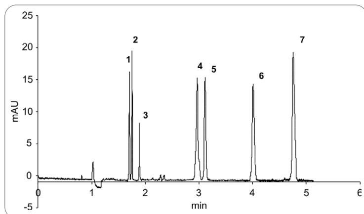
**Slika 3.** Elektroferogram simultane analize statina: (1) ketoprofen (unutarnji standard), (2) rosuvastatin, (3) pravastatin, (4) atorvastatin, (5) fluvastatin, (6) lovastatin i (7) simvastatin. Uvjeti analize: 25 mM boratni pufer pH 9,5, 25 mM SDS, 10 % (v/v) metanola, napon 23 kV, 30 °C, detekcija pri 237 nm, hidrodinamičko injektiranje 30 mbar, 4 s.
