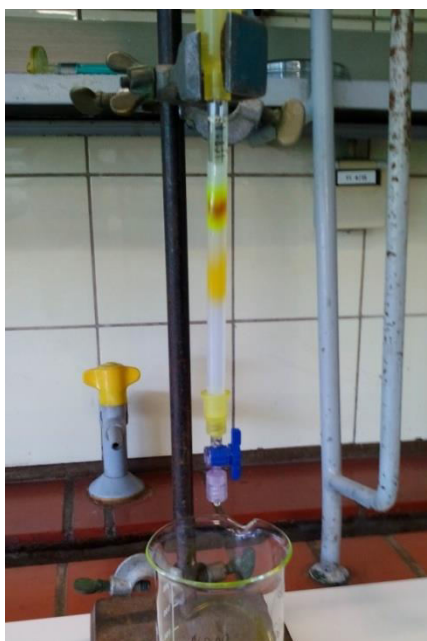
Slika 13. Odjeljivanje liposomski uklopljenog od neuklopljenog kalceina gel kromatografijom na koloni punjenoj Sepharosom CL-4B.
