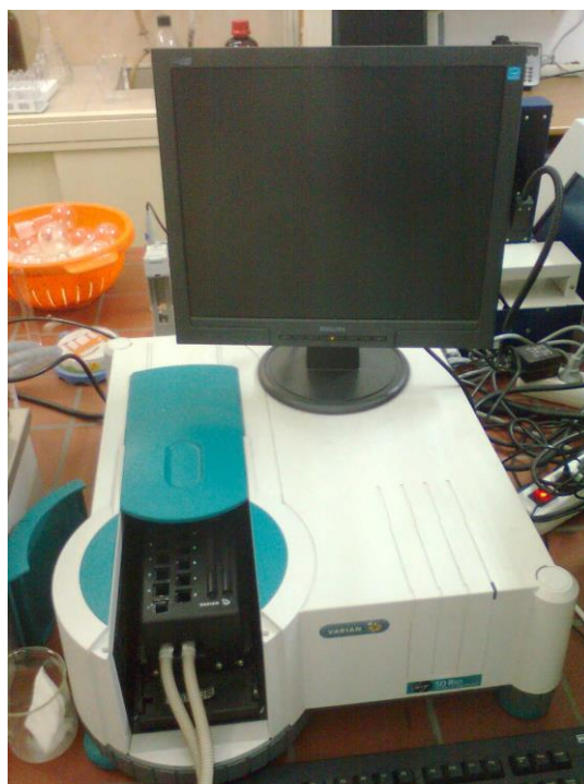
Slika 14. UV/VIS spektrofotometar Varian Cary 50 Bio
