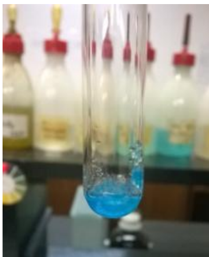
Slika 4. Azurno modro obojen kompleks [\text{Cu}(\text{NH}_3)_4]^{2+}
