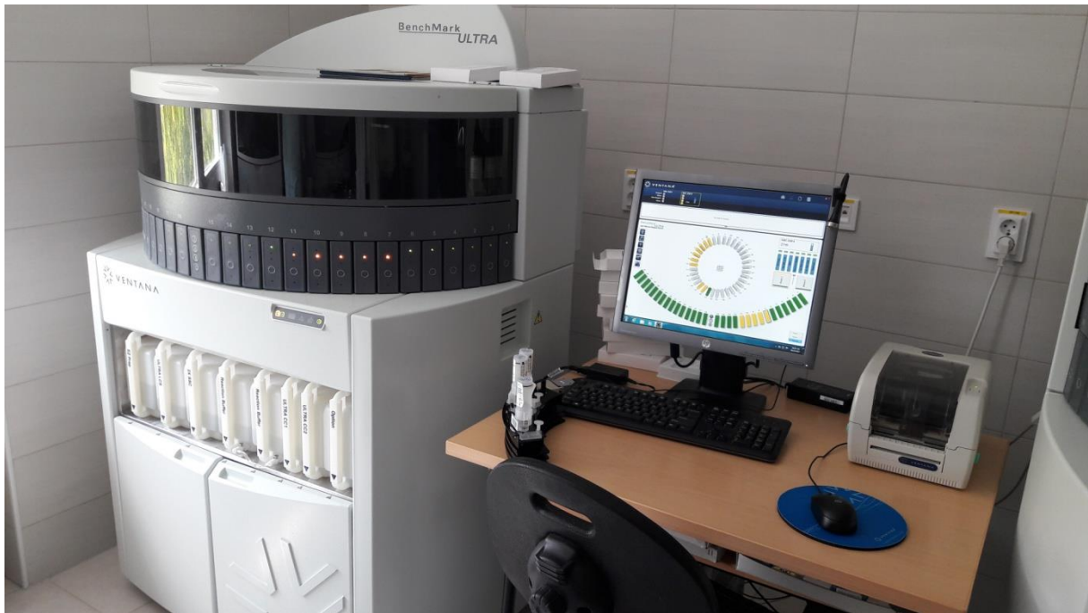
Slika 8. Imunohistokemijski laboratorij: Ventana BenchMark ULTRA aparat za imunohistokemijsku obradu tkiva i Inform Dual ISH metodu detekcije HER2-neu
