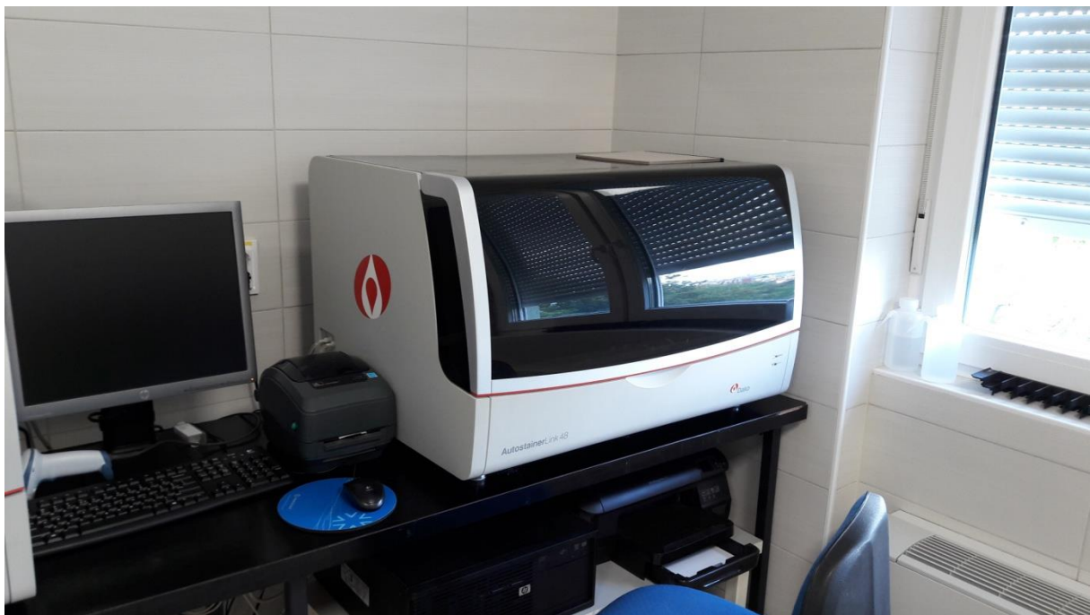
Slika 9. Imunohistokemijski laboratorij: Dako TechMate aparat za imunohistokemijsko bojenje
