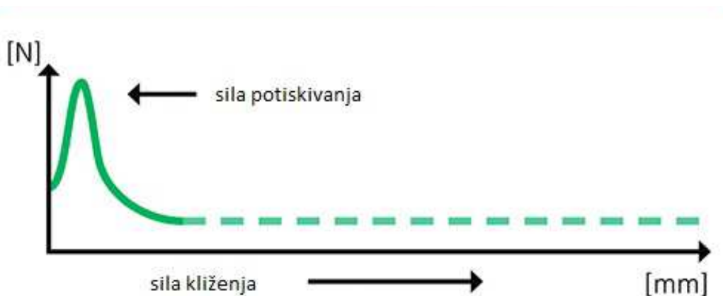
Slika 18. Grafički prikaz sile potiskivanja i sile kliženja
