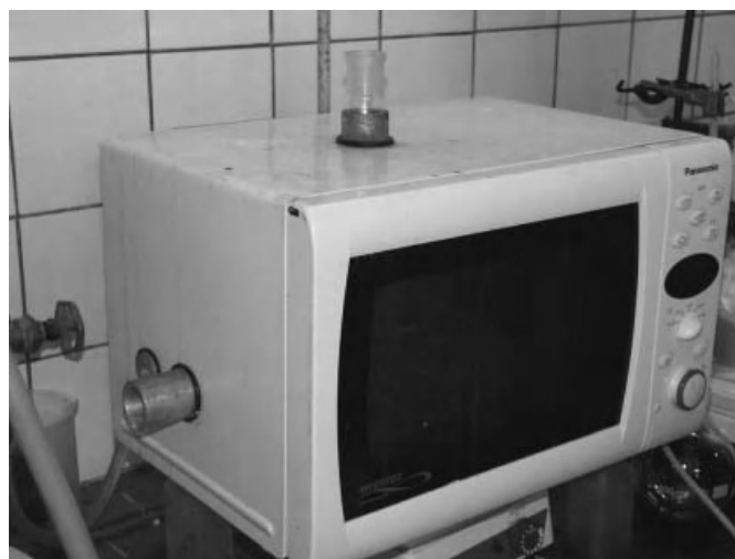
Slika 3. Kućanska mikrovalna pećnica modificirana za znanstvenu upotrebu. Na lijevoj strani su vidljivi otvori za IR termometar, na gornjoj je otvor za spajanje hladila, a ispod uređaja se nalazi magnetski mješač (Kappe i sur., 2012).
