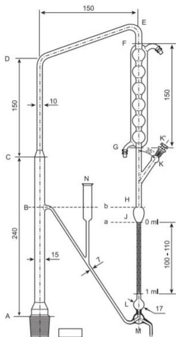
Slika 6. Dio aparature za određivanje eteričnih ulja u biljnim drogama; dimenzije su u mm
