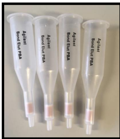
Slika 5: Korištene kolone za ekstrakciju čvrsto-tekuće, Bond Elut PBA (Anamarija Bogić)
