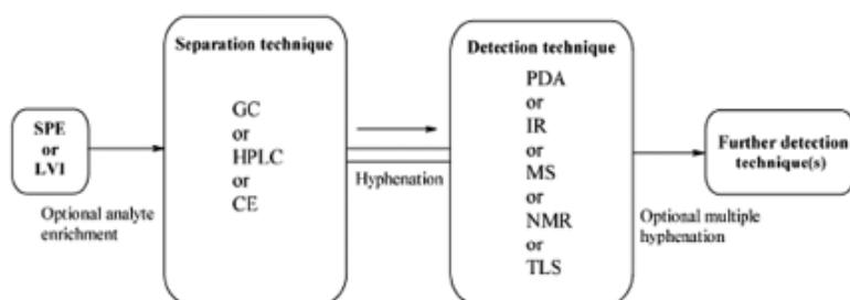
**Slika 2.** Shematski prikaz sprezanja analitičkih tehnika; preuzeto iz [10].
