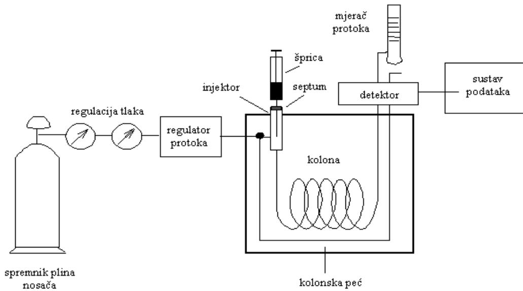
**Slika 1.** Shematski prikaz plinskog kromatografa; preuzeto iz [6].
