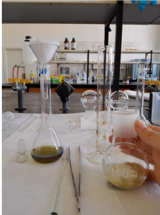
Slika 22. Propuštanje ekstrakta kroz vatu.
