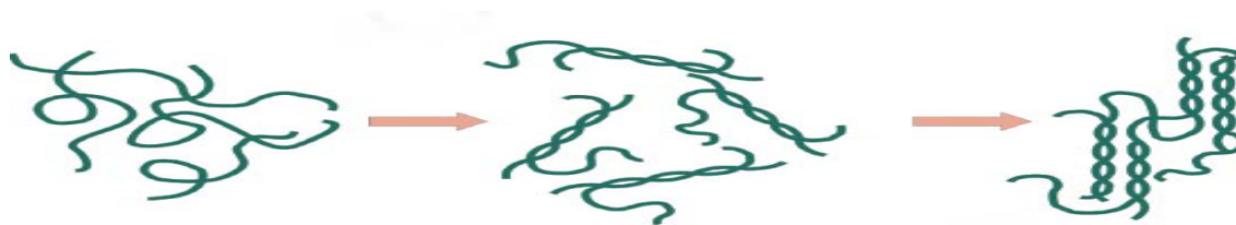
Slika 3. Postupni prijelaz vodene otopine gelan gume u gel (preuzeto i prilagođeno prema Osmalek i sur. 2014).
