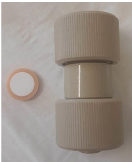
Slika 4. CIM r-Protein G Disk monolitna kolona
