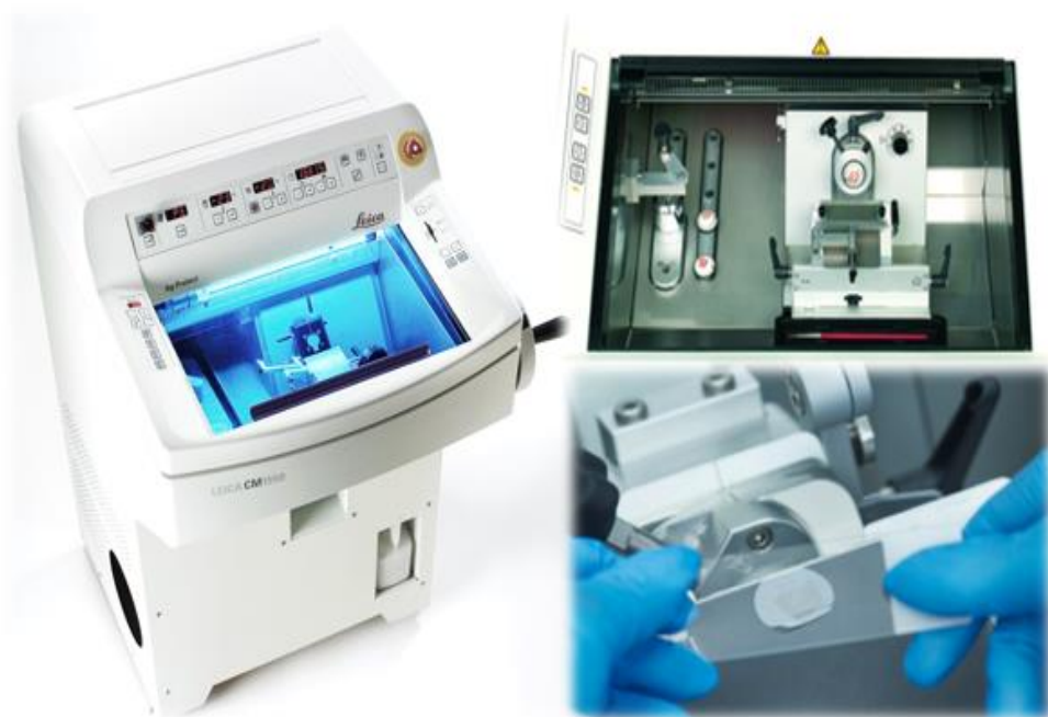
Slika 14. Kriomikrotom za izradu konsektivnih nerezaka jetre potrebnih za imunohistokemiju. (www.sakuraus.com)
