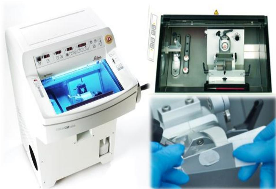
**Slika 14.** Kriomikrotom za izradu konsekutivnih nerezaka jetre potrebnih za imunohistokemiju. ([www.sakuraus.com](http://www.sakuraus.com))
