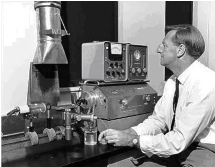
Slika 5. Sir Alan Walsh (1916-1998) sa svojim atomskim apsorpcijskim spektrofotometrom (Preuzeto sa https://web.nmsu.edu/~esevosti/walsh.htm )
