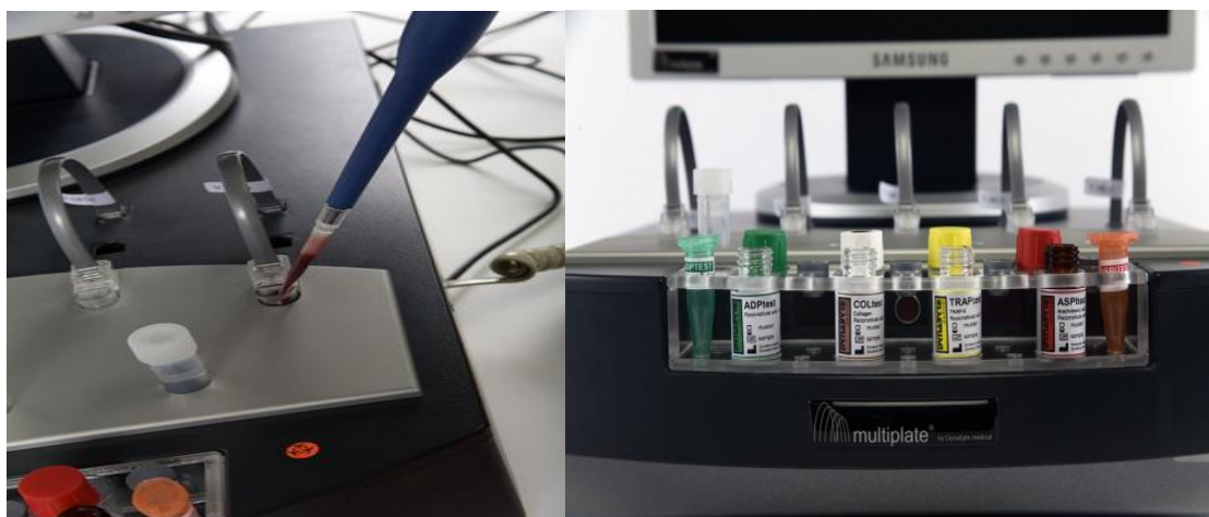
Slika 6B: Provedba testa agregacije: B) Stavljanje uzoraka krvi, reagensa i induktora agregacije automatskom pipetom u kivetu. Preuzeto iz www.diapharma.com
