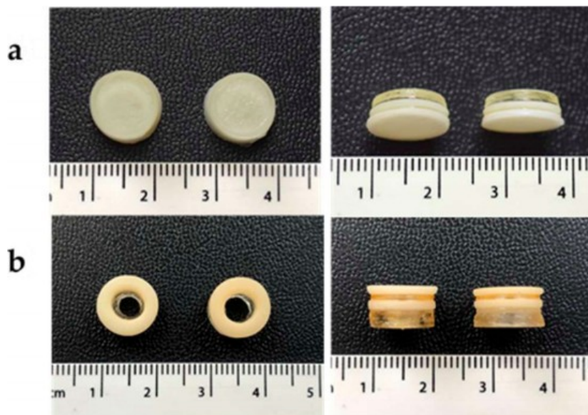
Slika 29. Isprintane polipil tablete: a) cilindrični oblik, b) oblik prstena (63).
