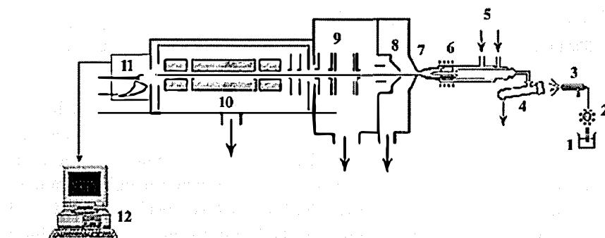
**Slika 3.** Shematski dijagram ICP-MS instrumenta: 1) tekući uzorak, 2) pumpa, 3) raspršivač, 4) komora za sprejanje, 5) ulazi za plin argon u baklju, 6) baklja, 7) prvi konus (engl. *sampler cone*), 8) drugi konus (engl. *skimmer cone*), 9) ionske leće, 10) kvadrupolni maseni analizator, 11) detektor multiplikator elektrona, 12) obrada podataka.
