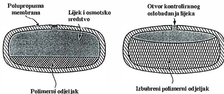
Slika 6. Shematski prikaz osmotskog sustava
