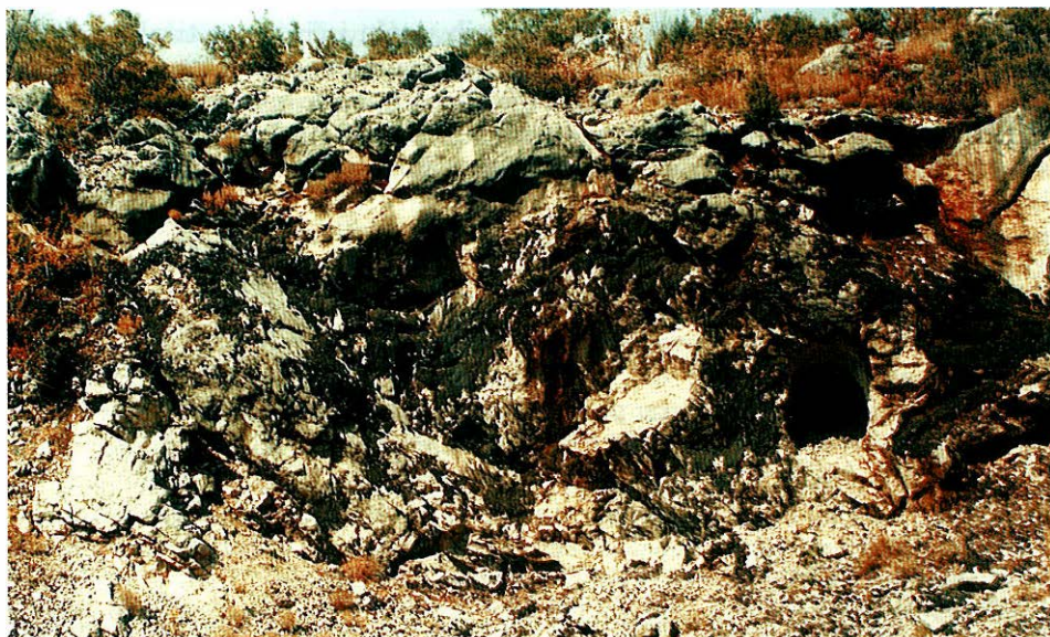
Površinski kop prirodnog asfalta, odnosno bituminoznog vapnenca i bituminozne vapnenačke breče u Paklini – Vrgorac
