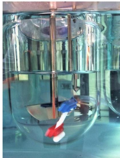
Slika 11. Dijalizacijska vrećica s magnetom i proba spektrofotometra s optičkim vlaknima u upotrebi (autorska fotografija)
