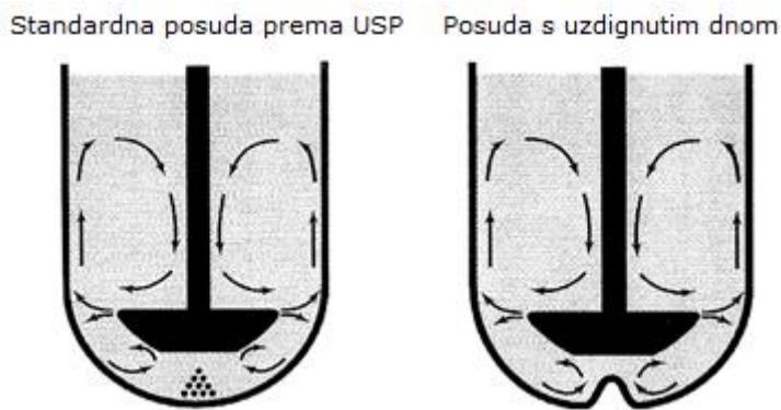
Slika 4. Uobičajena USP II aparatura i aparatura s posudom s uzdignutim dnom
