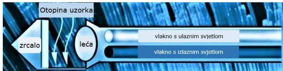
Slika 5. Shematski prikaz probe optičkim vlaknima potpomognutog spektrofotometra
