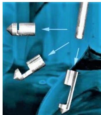
Slika 6. Probe od nehrđajućeg čelika s različitim duljinama optičkog puta (2 mm, 10 mm i 20 mm) (preuzeto s [www.agilent.com](http://www.agilent.com))
