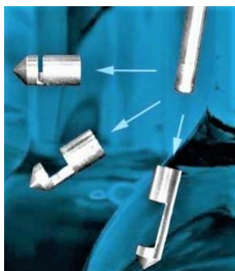
Slika 6. Probe od nehrđajućeg čelika s različitim duljinama optičkog puta (2 mm, 10 mm i 20 mm) (preuzeto s www.agilent.com )
