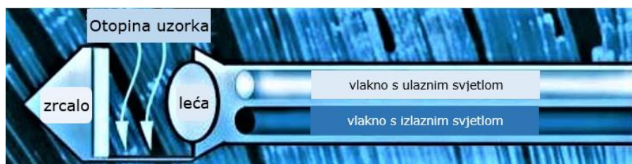
Slika 5. Shematski prikaz probe optičkim vlaknima potpomognutog spektrofotometra (preuzeto i prilagođeno s www.agilent.com )
