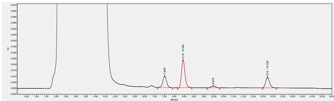
**Slika 30:** Kromatogram uzorka Dorzolamid 20 mg/ml i Timolol 5 mg/ml, kapi za oko, tretiranog vodikovim peroksidom.
