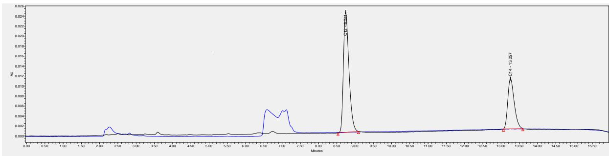
**Slika 9:** Kromatogram poredbene otopine analizirane mobilnom fazom koja sadrži fosfatni pufer i acetonitril (crno) i mobilnom fazom koja sadrži vodu umjesto fosfatnog pufera i acetonitriila (plavo).
