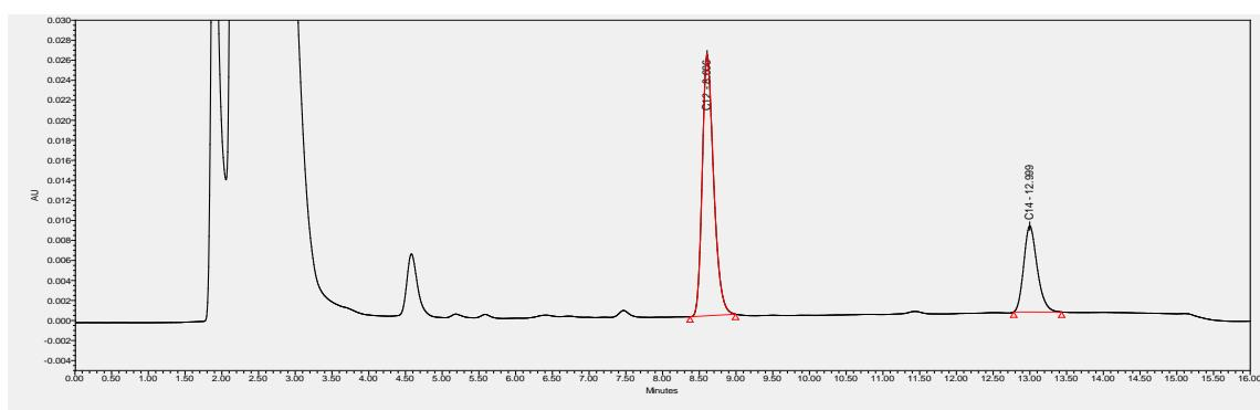
Slika 14: Kromatogram otopine uzorka Brimonidin 2 mg/ml, kapi za oko.
