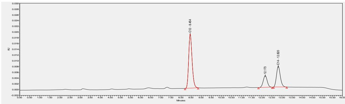
**Slika 20:** Kromatogram otopine uzorka Latanoprost 0,005% kapi za oko.
