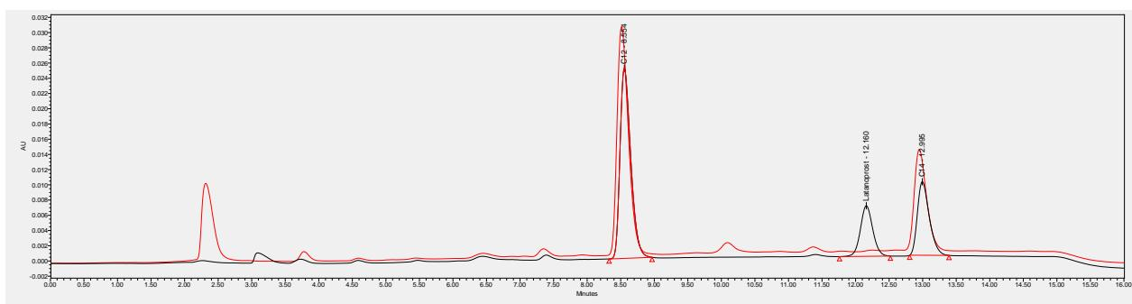
**Slika 8:** Kromatogrami septogala i latanoprost dobiveni gradijentom 1 kada su sastavnice PF pomiješane u bocama: septogal (crveno), latanoprost (crno).
