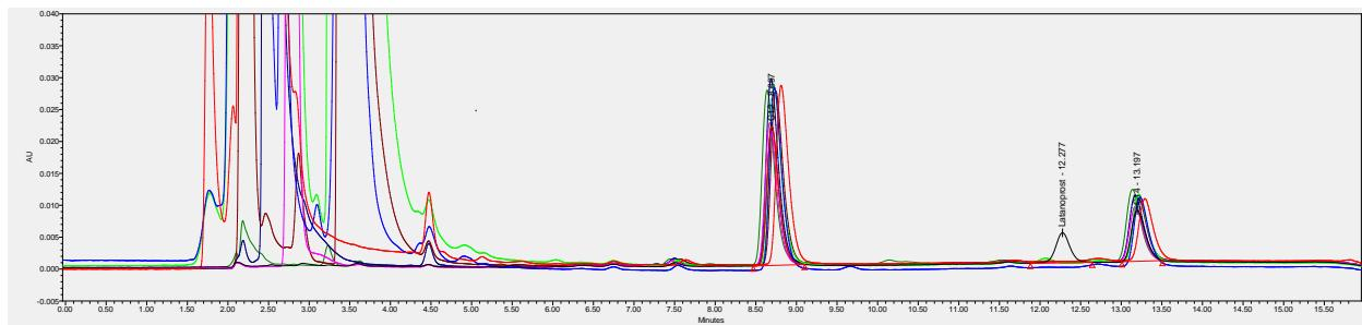
**Slika 11:** Preklopni kromatogrami svih uzoraka analizirani PF pomiješanom u bocama.
