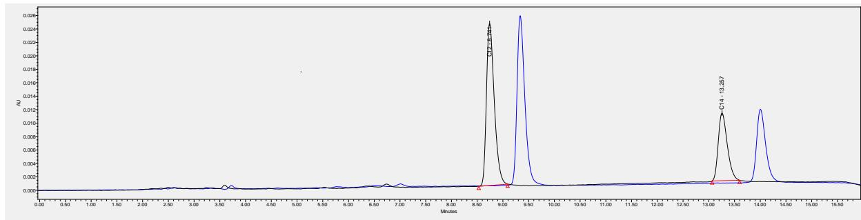
**Slika 10:** Kromatogrami poredbine otopine analizirane PF odvojene u bocama (plavo) i MF pomiješane u bocama (crno).
