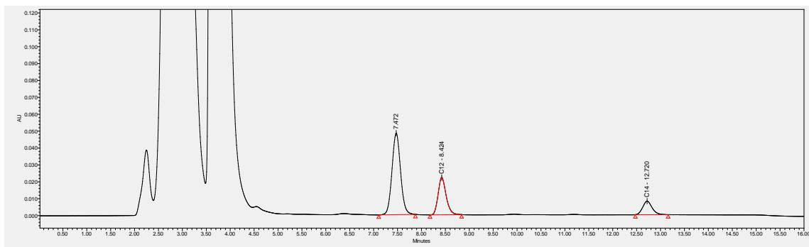
**Slika 31:** Kromatogram uzorka Timolol, 0,25%, kapi za oko, tretiranog vodikovim peroksidom.
