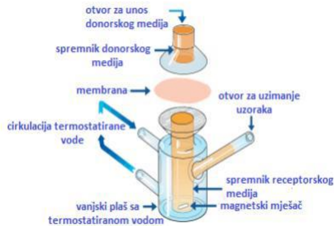
Slika 7. Franz difuzijska ćelija ( http://www.particlesciences.com )
