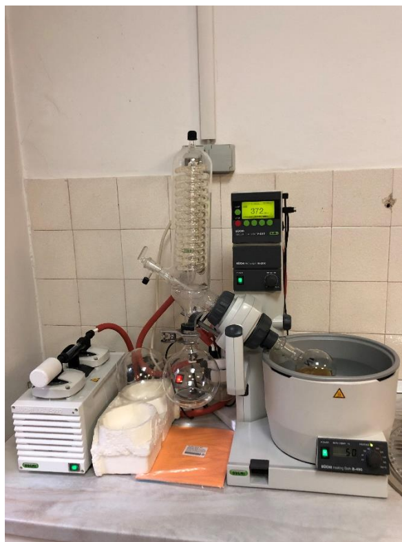
Slika 9. Uparavanje pomoću rotavapora (Fotografija: Anđela Dragaš)
