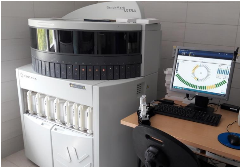
Slika 4. Automatizirani aparat Ventana BenchMark ULTRA za imunohistokemijsku obradu uzoraka i Inform Dual ISH metodu detekcije HER2-neu amplifikacije
