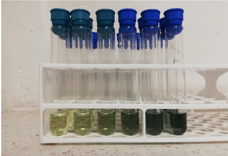
Slika 10. Koncentracijski niz standarda galne kiseline nakon sat vremena inkubacije
