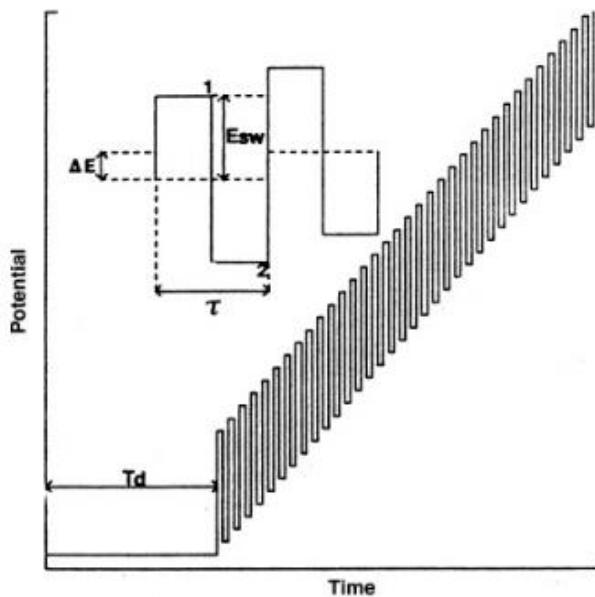
Slika 5. Prikaz pobudnog signala u pravokutnovalnoj voltametriji (Wang, 2000)
