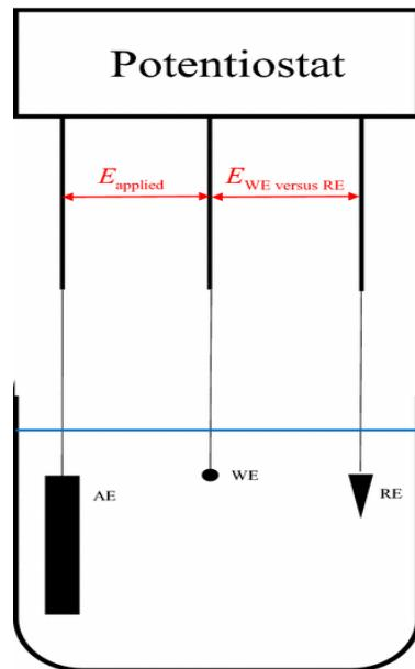
Slika 4. Elektrokemijski članak s tri elektrode i potenciostatom (Scholz, 2015),  $E_{\text{applied}}$ - primjenjeni napon, WE-radna elektroda, RE-referentna elektroda, AE-pomoćna elektroda
