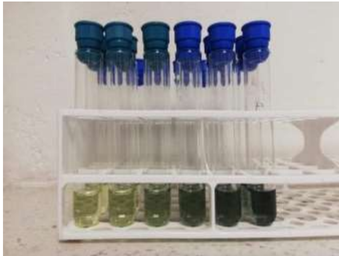
Slika 15. Kalibracijske otopine standarda galne kiseline nakon reakcije s reagensom
