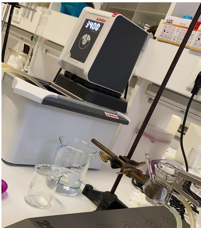
**Slika 12.** Ispitivanje bubrenja mikrosfera
