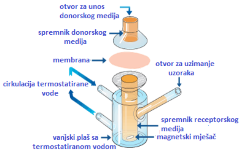
Slika 4. Franz difuzijska ćelija ( www.permegear.com )
