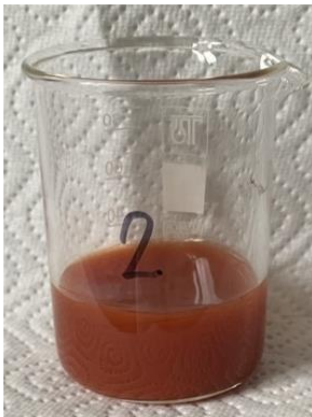
Slika 2. Uzorak 2, nakon završene reakcije po dodatku svih reagenasa i 20 minuta miješanja.
