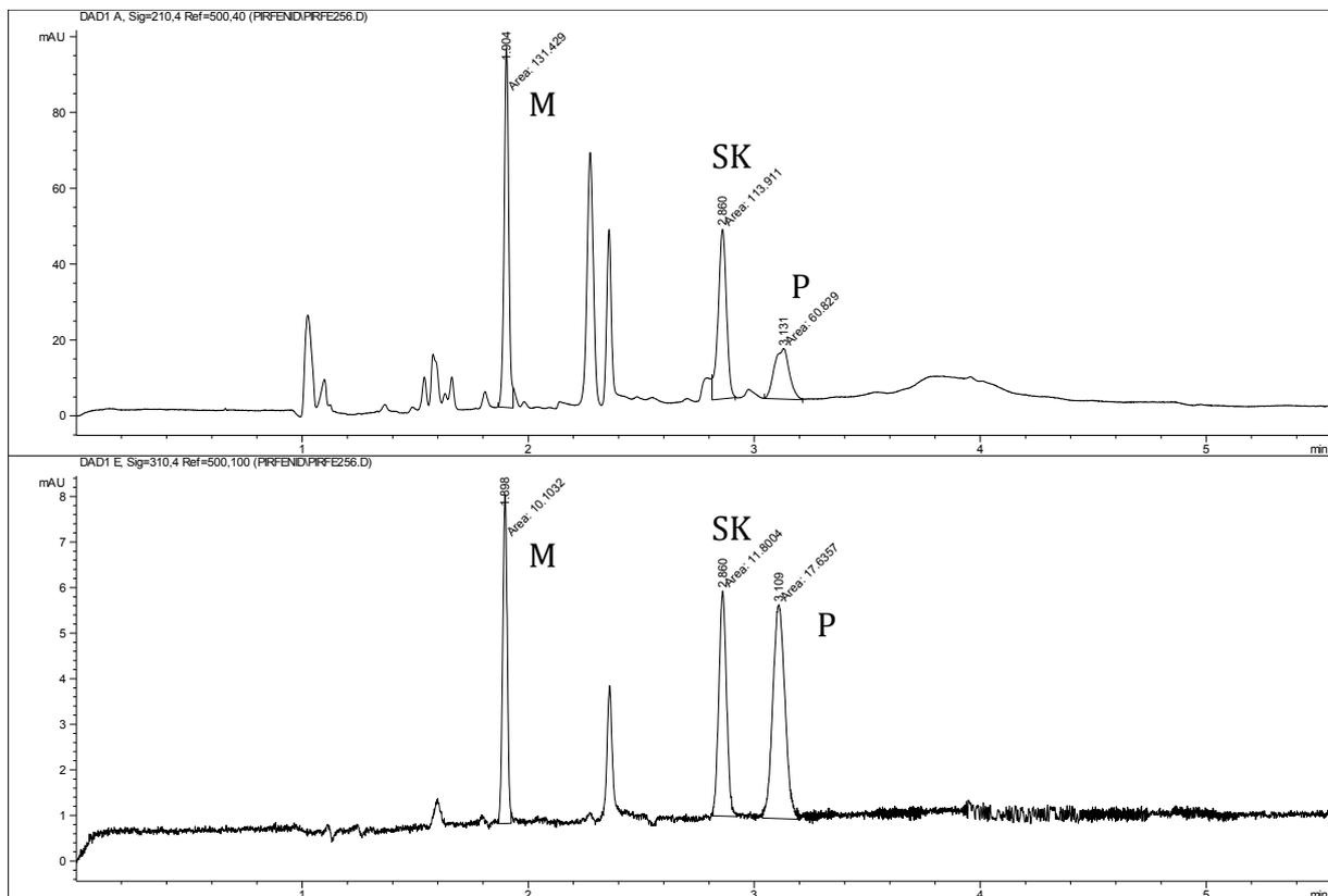
**Slika 24** Elektroferogram obogaćenog biološkog uzorka, snimljeno UV-Vis detektorom na: (A) 210 nm (B) 310 nm – (P) pirfenidon, (M) 5-karboxypirfenidon, (SK) salicilna kiselina
