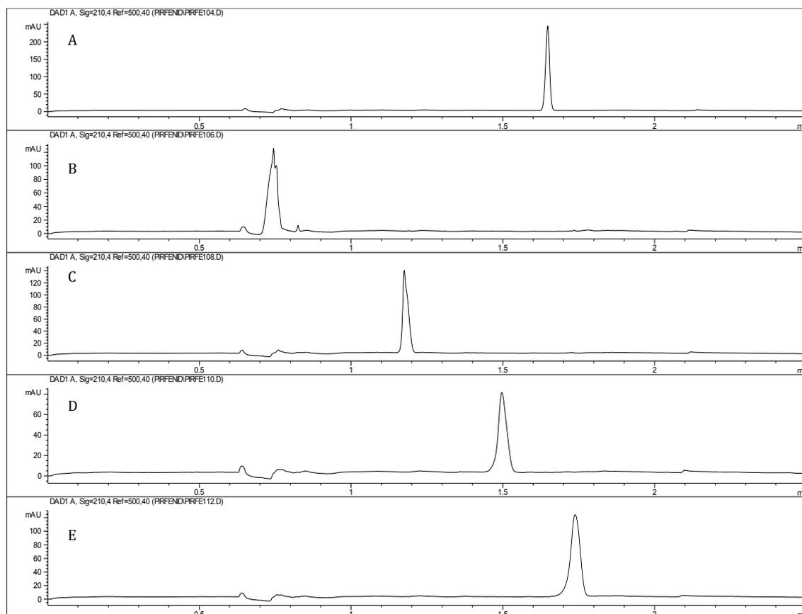
**Slika 14** Elektroferogrami potencijalnih unutarnjih standarda snimljeno na 210 nm.
