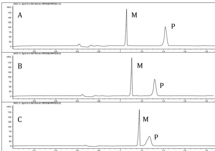
**Slika 13** Ovisnost vremena migracije standarda pirfenidona (P) i 5-karboksipirfenidona (M) o koncentraciji SDS: (A) 70 mM SDS, (B) 50 mM SDS, (C) 30 mM SDS
