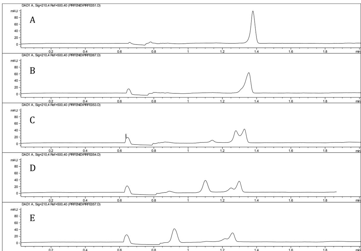
**Slika 11** Elektroferogrami otopine standarda pirfenidona u različitim otapalima: (A) čista voda, (B) voda:metanol = 90:10, (C) voda:metanol = 80:20, (D) voda:metanol = 70:30, (E) voda:metanol = 50:50
