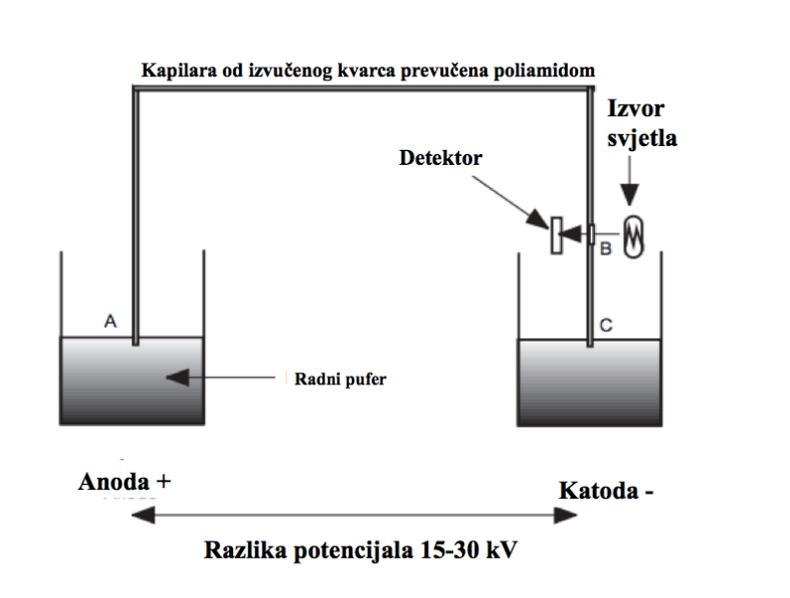
**Slika 1** Shematski prikaz uređaja za kapilarnu elektroforezu (Prilagođeno iz: Watson, 2012)
