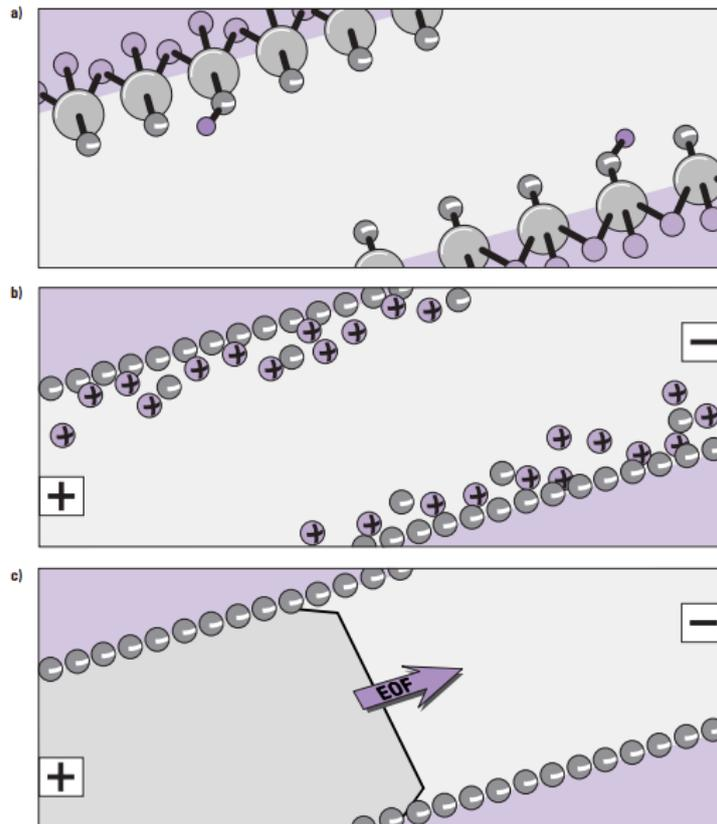
**Slika 2** Nastanak elektroosmotskog toka (EOF): **a)** negativno nabijene silanolne skupine na unutrašnjoj strani kapilare od izvučenog kvarcnog stakla, **b)** nastanak električnog dvostrukog sloja **c)** elektroosmotski tok prema katodi (preuzeto iz: Heiger D., 2000.)
