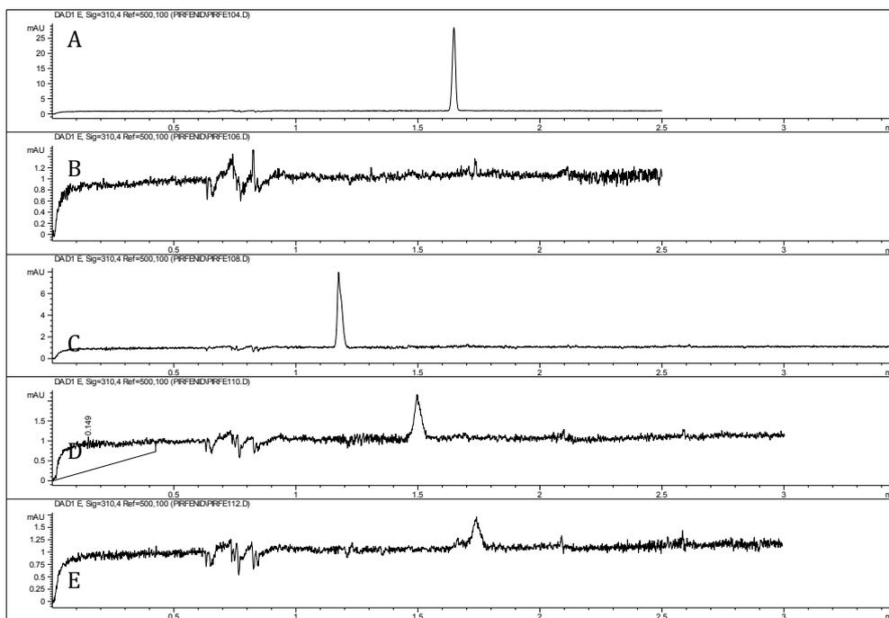
**Slika 15** Elektroferogrami potencijalnih unutarnjih standarda snimljeno na 310 nm. (A) salicilna kiselina, (B) kofein, (C) ketoprofen, (D) propifenazon, (E) kodein
