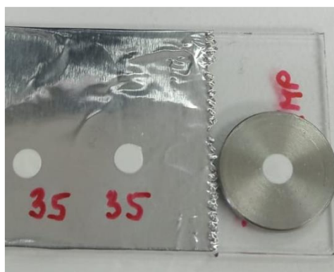
Slika 10. Isprešani diskovi i prsten za diskove
