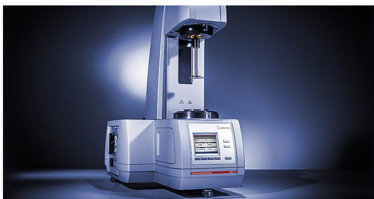
Slika 8. MCR 102 reometar (Anton Paar, GmbH, Austrija; preuzeto s www.anton-paar.com/ )
