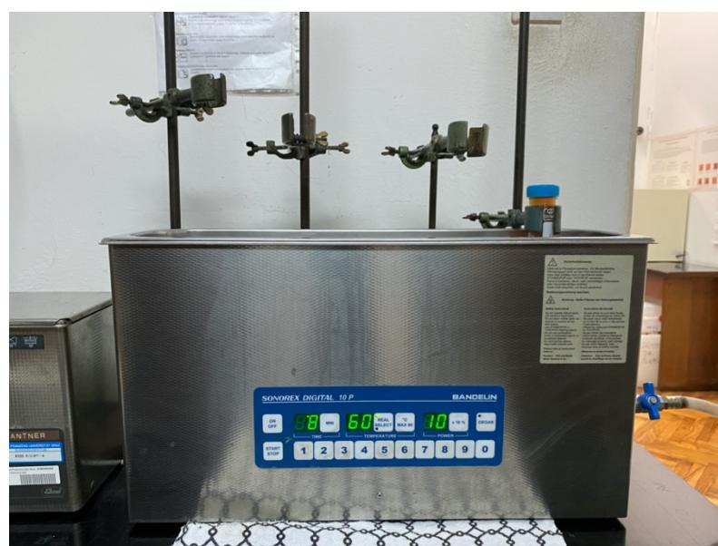
Slika 6. Ultrazvučna vodena kupelj, Zavod za farmakognoziju
