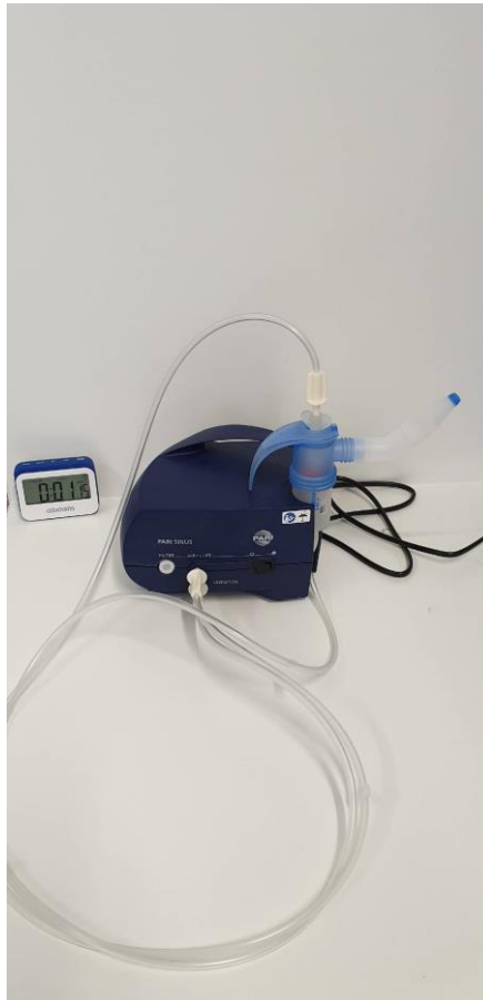
Slika 7. Nebulizator Pari Sinus TM pripremljen za ispitivanje ujednačenosti doziranja in situ gelirajućih nanosuspenzija flutikazonpropionata
