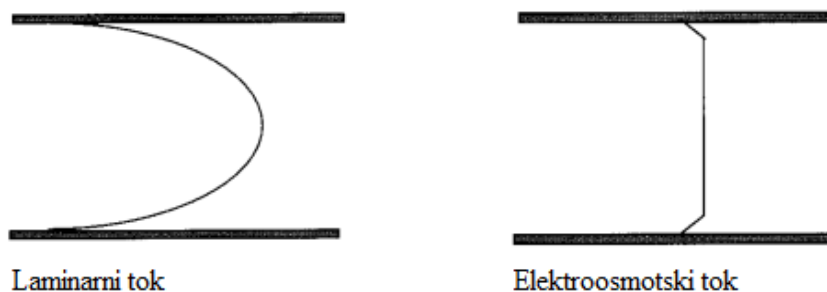
Slika 3. Laminarni tok tekućinske kromatografije i elektroosmotski tok kapilarne elektroforeze (Prilagođeno iz: Watson, 2012).
