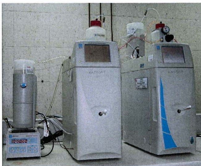
Slika 2. Ionski kromatograf ICS 2000 Dionex.
